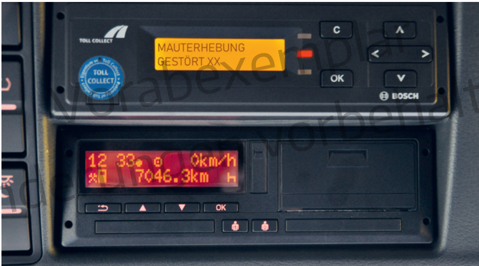
12 OBU mit Fehlermeldung und roter LED
